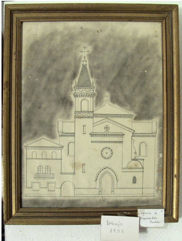
Dibuix de la façana de l'església tal com estava projectada, amb la torre del campanar amb 'chapitel' com el de Torre la Mina, que no es va fer per falta de pressupost. Tiralínies sobre paper, signat per l'autor ('Juan S. Vicent') i datat el 24-5-1953.
